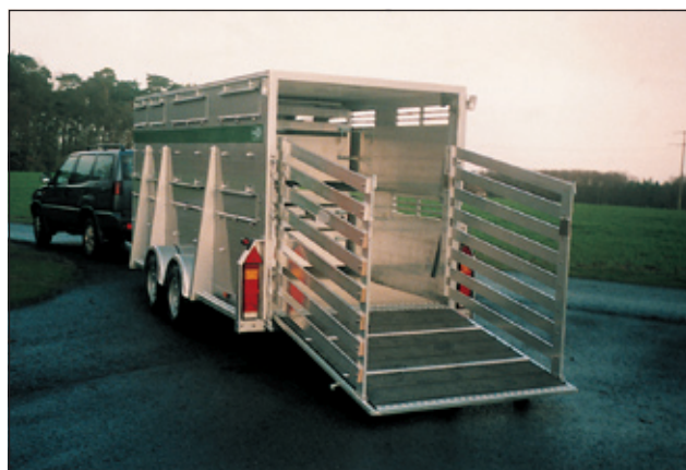
mit geschlossenen Seitenstreben und Doppelboden aus Alu-Profilen
