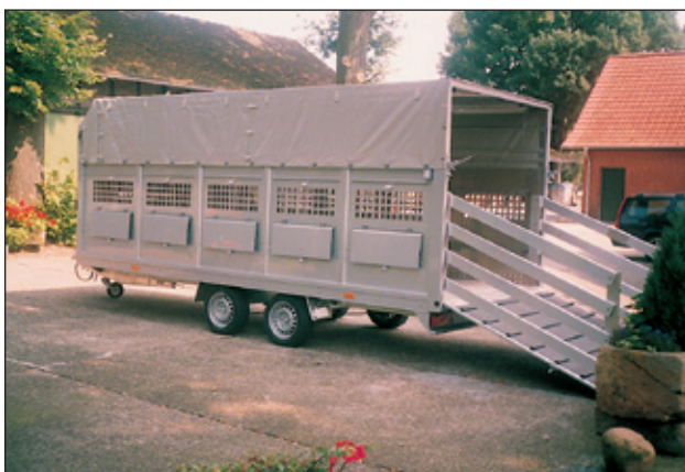
4500 x 1950 x 1900 mm Scherengitter als seitliche Abtrennung
