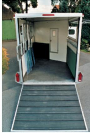
Innenraum mit Gießgummiboden und Trittschutz an den Wänden
