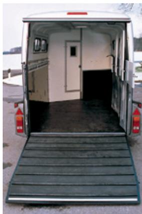
Innenraum mit Gießgummiboden und Trittschutz an den Wänden, Trennwand optional
